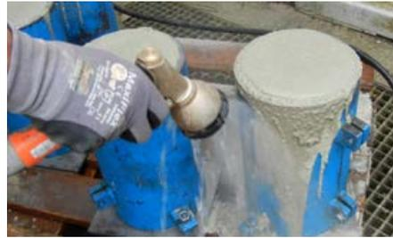
Abbildung 4: Reinigen von zementgebundenen Mineralguss mit Wasser
