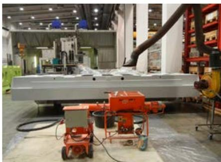
Abbildung 2: Verfüllen mit Mischer und Pumpe
